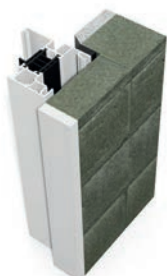
POSE EN FEUILLURE SANS RECOUVREMENT
