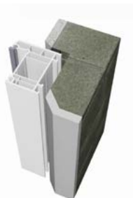
POSE EN FEUILLURE SANS RECOUVREMENT
